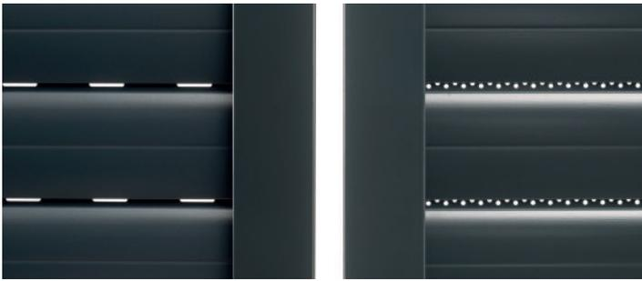
**Lames nervurées** en aluminium thermolaqué de 37 mm de hauteur, revêtues à l'intérieur de mousse de polyuréthane sans CFC. Les lames peuvent être fournies également dans la version **microperforée** pour assurer la ventilation des pièces sans laisser pénétrer les insectes, ou avec les **ajours** plus traditionnels, qui permettent d'utiliser le produit pour presque toutes les réparations et remplacements de produits existants.
