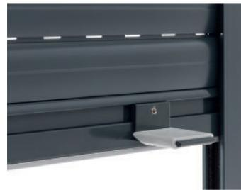
**Les coulisses latérales** de 19 x 27 mm, en aluminium extrudé anodisé ou thermolaqué, sont complétées par des joints brosses d'insonorisation. Des coulisses de 19 x 40 mm sont fournies pour les largeurs de plus de 2'500 mm afin d'offrir une meilleure stabilité au tablier.
